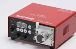
LOCTITE 98548 es ideal para dosificar los adhesivos directamente desde el bote. El movimiento peristáltico del rotor proporciona dosificación volumétrica del adhesivo directamente desde el bote o un envase similar. La unidad ha sido diseñada principalmente para estaciones de trabajo manuales, pero puede integrarse también en líneas de producción automáticas. Permite aplicaciones precisas y asegura una alta exactitud en la repetición.
