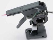
LOCTITE 98810 es una pistola manual volumétrica que proporciona dosificación precisa y repetible de adhesivos de cianoacrilato (hasta 1.500 cPs) directamente desde el envase estándar de 20 g. Permite aplicar cada gota de adhesivo exactamente donde se necesita.
