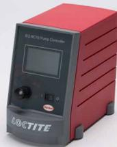
LOCTITE EQ RC15 proporciona control a las bombas de rotor compactas 97611 y 97621. Asegurando la aplicación precisa de gotas y cordones. La velocidad de flujo y el volumen de la dosificación se pueden controlar con +/-1% de exactitud. La consola de control puede invertir la rotación de la bomba de rotor, lo que evita que el producto gotee al crear un efecto específico de rechupe.
