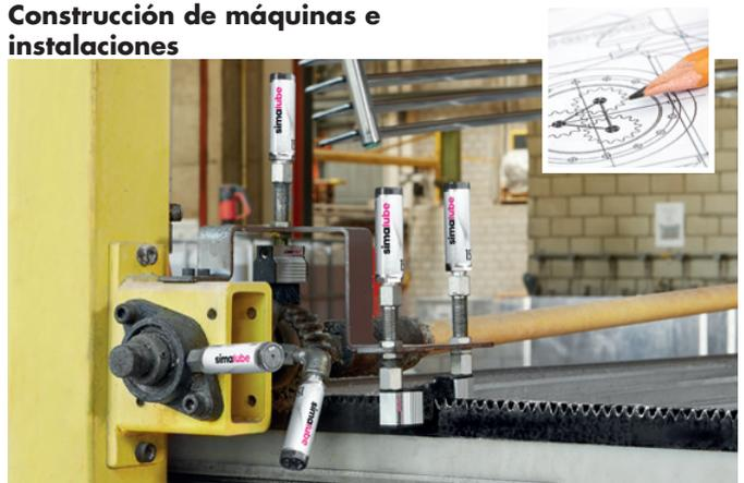
El lubricador simalube de 15 ml que incorpora un cepillo abastece constantemente con aceite la cremallera de una máquina de carga. Otros lubricadores simalube de 15 ml lubrican el soporte de brida con grasa.
