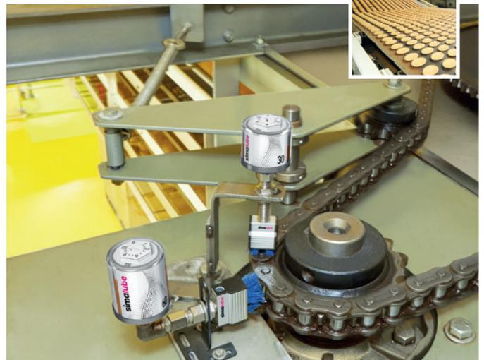
La cadena de transmisión de una cinta de transporte y refrigeración de panecillos se limpia con cepillos especiales azules y se lubrica con 2 simalube SL18 en tamaños de 30 y 60 ml.
