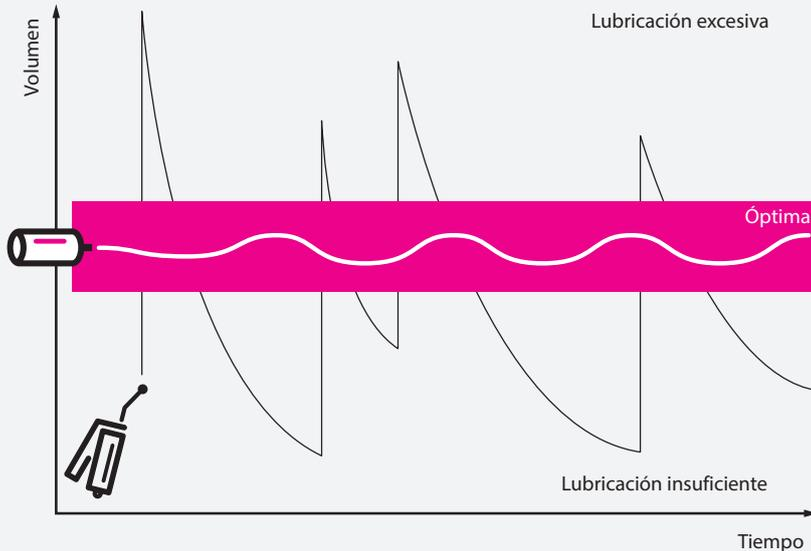
La descarga continua de lubricante con simalube evita eficazmente la lubricación insuficiente o excesiva que a menudo aparece con la lubricación manual.
