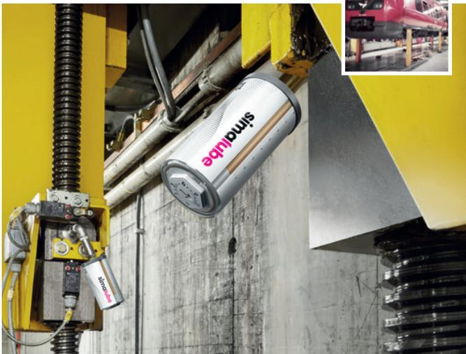
Los husillos de un sistema de elevación para vagones y locomotoras se lubrican con simalube 125 ml durante de 12 meses.
