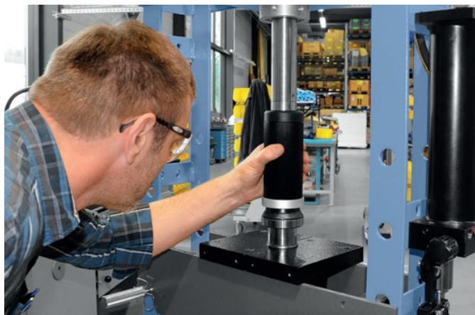
El FT-P es la solución ideal para instalaciones con mayores cargas, ya que la herramienta se puede utilizar en una prensa. Anillos de aluminio de alta calidad que no se deforman incluso con fuerzas de presión de 5 toneladas.
