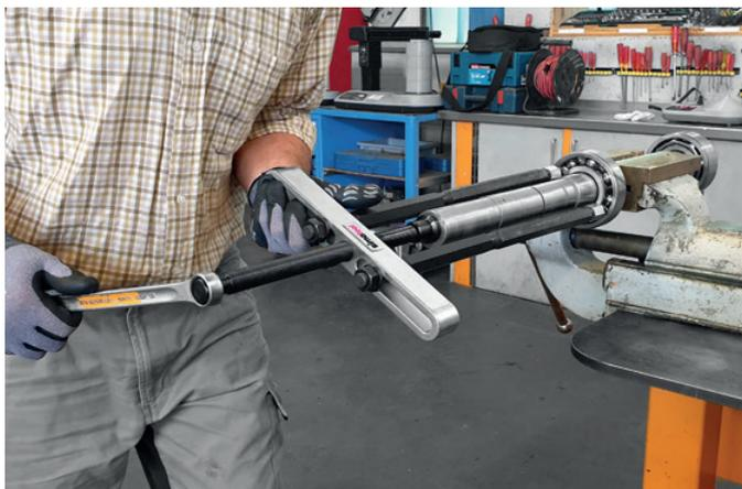
Con la ayuda de extensiones, el kit de herramientas de desmontaje BP 160 también permite desmontar rodamientos de difícil acceso de manera fácil y profesional.
