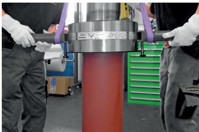
El Bearing Handling Tool BHT permite levantar fácilmente y montar de una manera controlada el rodamiento de rodillos oscilantes pesado precalentado en la turbina.
