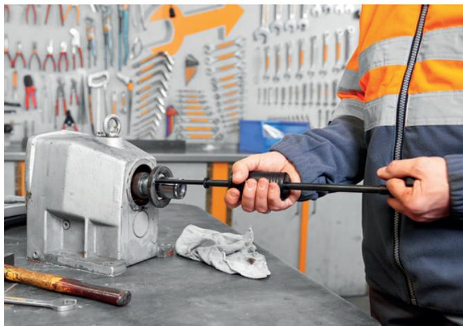
Pericia técnica: desmontaje de una junta del eje de una transmisión utilizando la simatool Seal Puller SP 50.
