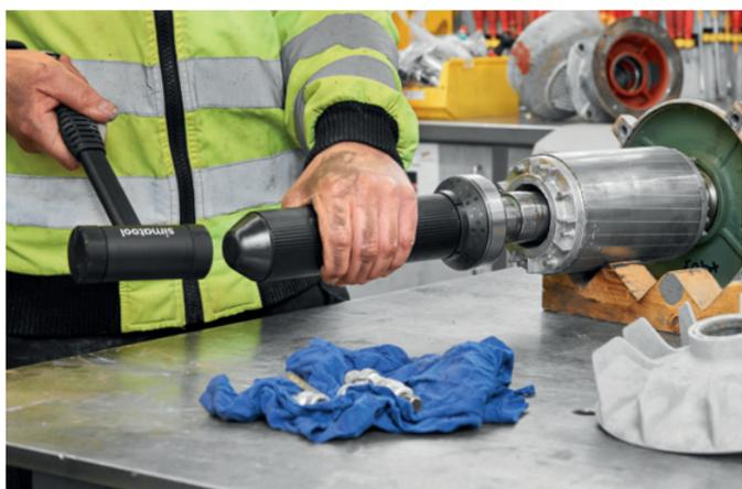
Gracias al Fitting Tool FT 33, durante el montaje, las fuerzas se transmiten de manera uniforme al nuevo rodamiento.
