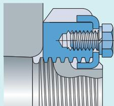
Fija con un seguro de fijación separado que está unido a la tuerca y engancha con un canal chavetero en la rosca del eje y una de las ranuras de la tuerca
