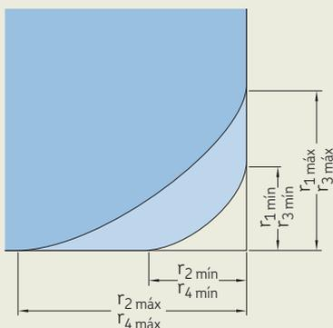
Tolerancias normales para rodamientos radiales, excepto los rodamientos de rodillos cónicos
