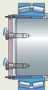
juego radial interno para obtener el ajuste de interferencia correcto se detallan en la sección del producto correspondiente.
