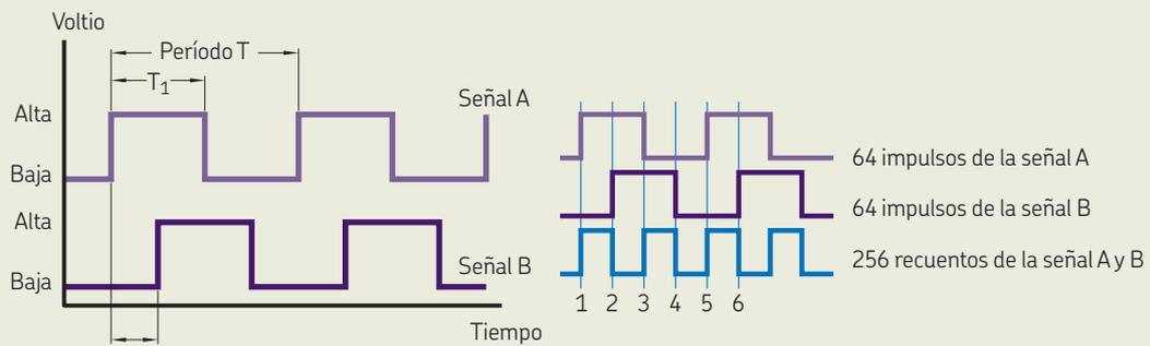
Cambio de fase = +90° cuando el aro interior gira en el sentido de las agujas del reloj, desde la perspectiva del lado del sensor
