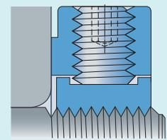
Fija al apretar los prisioneros para presionar una inserción roscada de acero en la tuerca de fijación contra la rosca del eje
