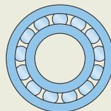
Distancia de los rodillos de un rodamiento estándar con jaula (no se muestra la jaula)
