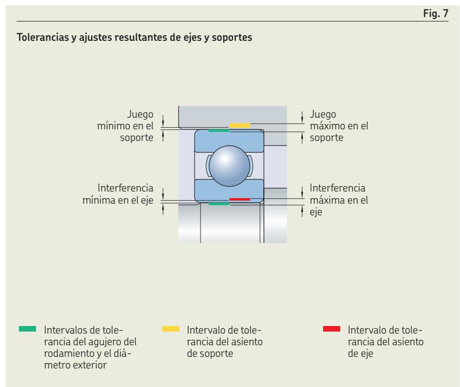
Tolerancias del eje y ajustes resultantes
