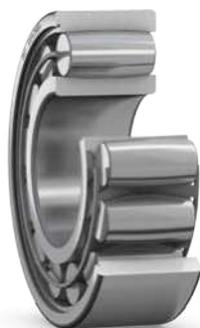
Los rodamientos de rodillos toroidales CARB (fig. 1) cuentan con una hilera de rodillos largos, ligeramente abombados y simétricos, y perfiles de los caminos de rodadura toroidales (fig. 2). Son rodamientos libres y soportan exclusivamente cargas radiales. Los rodamientos CARB se suelen utilizar para reemplazar el rodamiento de rodillos a rótula del lado libre en una disposición de rodamientos del lado fijo/libre.
