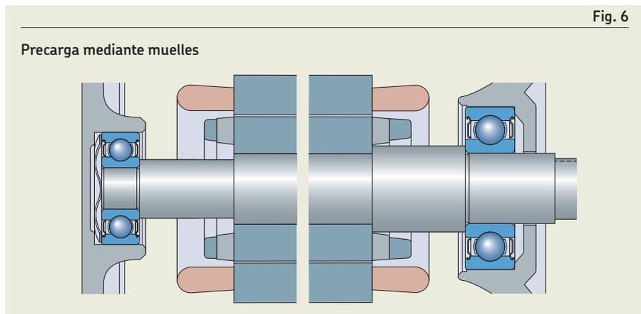
Para motores eléctricos pequeños, se emplean valores comprendidos entre 0,005 y 0,01 para el factor  $k$ . Si el objeto principal de la precarga es proteger el rodamiento contra cualquier daño que pueda sufrir a causa de las vibraciones externas cuando está en posición fija, entonces se precisa una precarga mayor y se debe aplicar el factor  $k = 0,02$ .
