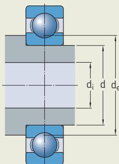
Para las relaciones de los diámetros del eje  $c_i > 0,5$ , se debe ajustar la tolerancia del diámetro determinada para un asiento en un eje macizo, para lograr un ajuste con la misma eficacia en el eje hueco. Esto se puede realizar mediante el siguiente procedimiento.
