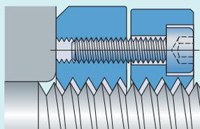
Se fija a la rosca del eje por la fricción generada al apretar tres pasadores de fijación radiales con prisioneros contra sus flancos no cargados
