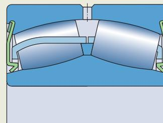
La grasa debe aplicarse lentamente a través de los orificios de lubricación en el aro exterior, preferentemente mientras el rodamiento gira, a fin de evitar dañar los sellos. SKF recomienda relubricar el rodamiento con la misma grasa con la que se realizó el llenado inicial.
