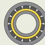
Rodamiento desmontable de alta capacidad con jaula centrada respecto del camino de rodadura del aro interior
