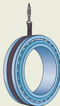
el peso del rodamiento, ya que el tamaño y la profundidad del orificio se limitan al grosor del aro. Asegúrese de que los cáncamos estén sometidos únicamente a una carga en la dirección del eje del vástago (fig. 26).
