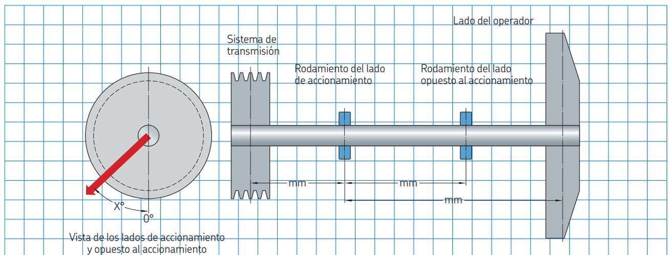
Para una configuración diferente, añadir un plano de montaje con la distancia correspondiente de los diferentes componentes y la orientación de la carga.
