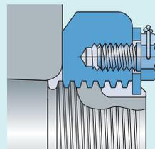
Fija con una placa de fijación que engancha con un canal chavetero en la rosca del eje y se asegura a la tuerca mediante dos tornillos y alambre de fijación
