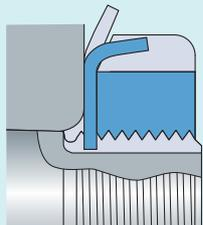
Fija con una arandela de fijación separada enganchada en un canal chavetero en la rosca del eje y con una lengüeta que se dobla hacia una de las ranuras de la tuerca
