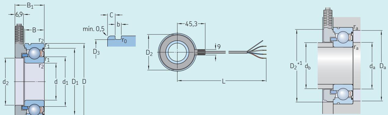
Diámetro del agujero de la cubierta lateral  $\geq D_2 + 1$  mm
