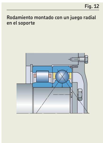
En estas circunstancias, SKF recomienda el juego de funcionamiento cero, que se puede obtener mediante el uso de muelles. Cuando los muelles no son suficiente, puede ser de ayuda utilizar rodamientos de respaldo con un ángulo de contacto de 25°.
