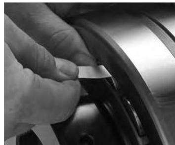
Fig. 18. Medida del RIC antes de la instalación.
