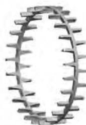
Fig. 7. Jaula de latón maquinado de una pieza, tipo saliente y con desplazamiento de rodillos.
