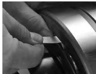
**Fig. 14. Medida del RIC antes de la instalación.**
